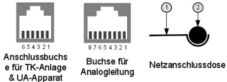
Abbildung 4.59: Details zur Netzanschlussdose
