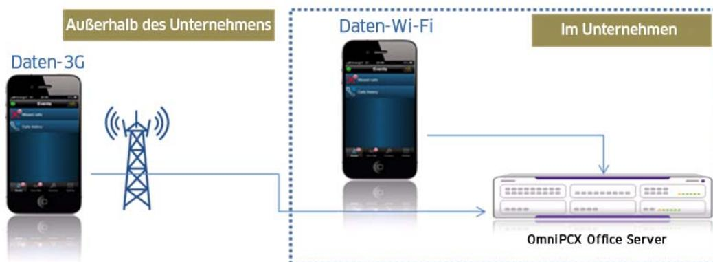
My IC Mobile für iPhone ist über einen sicheren HTTP-Zugang mit der Infrastruktur des Unternehmens verbunden. Hält sich der Benutzer außerhalb des Unternehmens auf, erfolgt die Verbindung über einen 3G/Edge-Datenkanal. Befindet er sich innerhalb des Unternehmens, kann die Verbindung auch über Wi-Fi® hergestellt werden.
