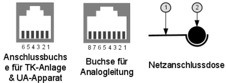
Abbildung 4.59: Details zur Netzanschlussdose
