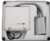
IP-DECT AP mit externen Antennen mit 8dBi Verstärker-Antenne oder anderen externen Verstärker-Antennen
