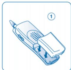
Den Akku entsprechend der auf dem Etikett angegebenen Markierung in die Schiebeleiste einlegen
